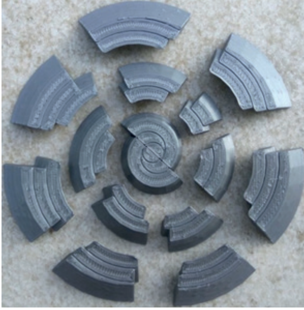
Şekil 11. Düz Tonoz Hacminin Üç Boyutlu Olarak Yeniden Yapılandırılması
